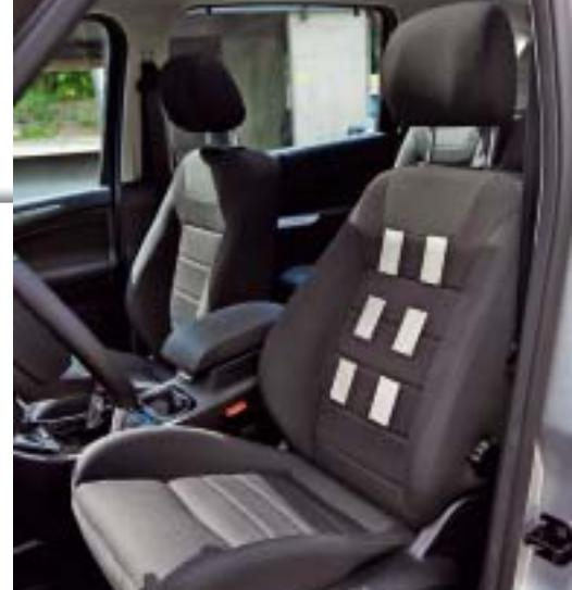
Des composants permettant une mesure capacitive de l'électrocardiogramme sont intégrés au dossier de ce siège. Photo : Ford
